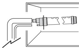
DP\*: линейный парораспределитель (вх. Ø 22 мм, Ø 30 мм, Ø 40 мм)
