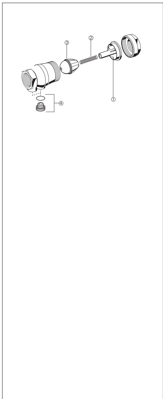
**Запчасти для обратных клапанов RV 280
