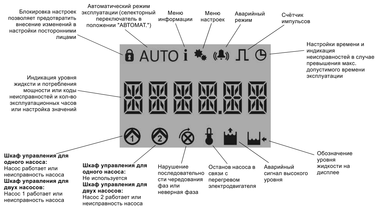
Рис. 119. Панель управления шкафов для установок с одним насосом
