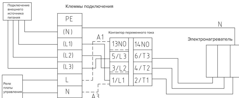
P S. При подключении к сети 380 В три фазы 380 В подключаются к (L1) ,(L2), (L3) и нулевой линии (N). На печатной плате блока нулевая линия и линия фазы подключаются к N. L
