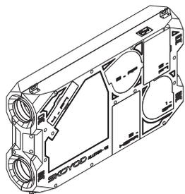
Снимите крышку предфильтра фильтра 5-F7
