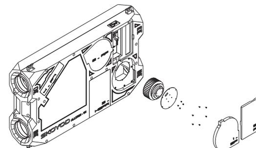
Сначала снимите крышку HEPA-фильтра
