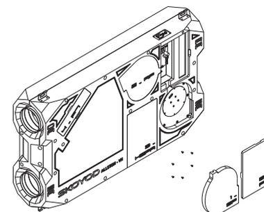
Затем закрутите винты, установите двигатель обратно в устройство EPP, подключите линию.
