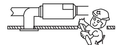
Не устанавливайте устройство на наклонных потолках.
