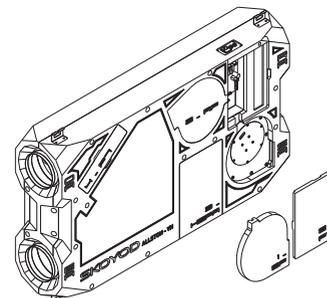
Затем выкрутите 4 винта М4, отсоедините провод двигателя, вставленный в печатную плату, а затем замените двигатель
