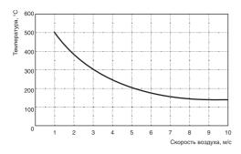
Температура на поверхности ТЭНов воздухонагревателей зависит от скорости потока воздуха через нагреватель и коэффициента теплосъема с поверхности нагревателей. На графике показана зависимость температуры на поверхности нагревательных элементов от скорости потока воздуха. Температура воздуха на выходе составляет около 20 °C.
