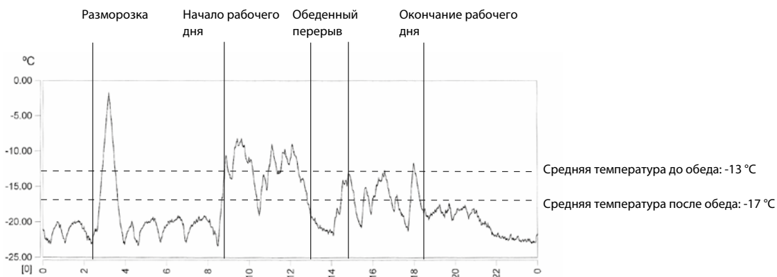
Суточные изменения температуры. Проем защищен воздушными завесами.
