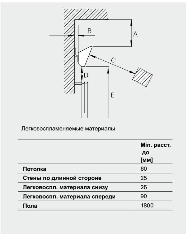
Рисунок 1: Минимальные расстояния при подвеске на стену.
