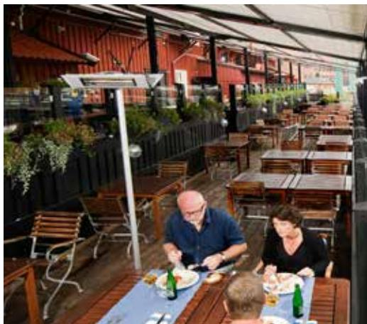
Прибор может крепиться на переносной стойке, которая поставляется как принадлежность. При применении специальной скобы, на переносной стойке могут устанавливаться три прибора, тогда тепловой поток будет распределен равномерно во все стороны.
