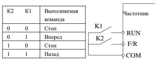
Рис. 6-14 Двухпроводной режим управления 2
