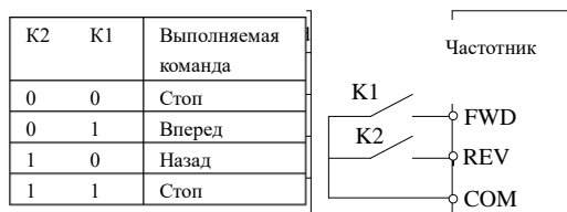
Рис.6-13 Двухпроводной режим управления 1
