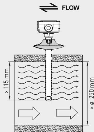
Датчик / измерительный преобразователь содержания углекислого газа, каналный, вкл. присоединительный фланец, самокалибрующийся, с переключением диапазонов измерения и активным / релейным выходом
