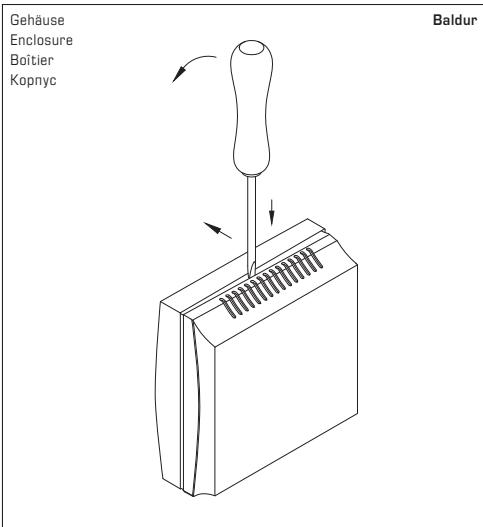
Zum Öffnen des Gehäuses einen Schraubendreher (2,0) in die Nut mittig ansetzen, nach unten drücken und den Bodenrahmen etwas anheben. Den Deckel nach vorne ziehen und halten.
