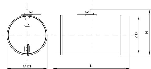
Воздушные клапаны ZSK-R предназначены для регулирования воздушного потока при пусконаладке системы и перекрытия воздушных каналов во время остановки работы систем вентиляции.
