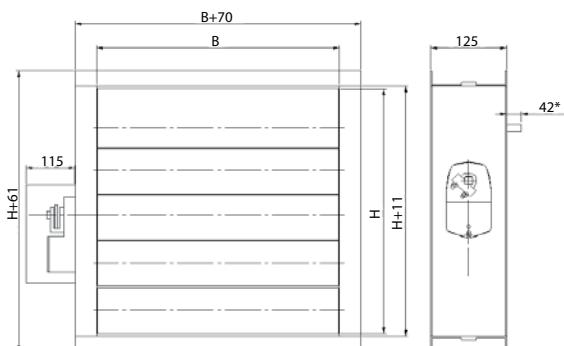
Размер В - параллельно осям вращения жалюзи, ограничивается прочностными расчетами при давлении вентиляции.
