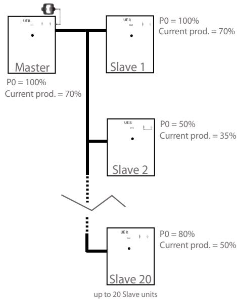
Схема соединения ведущего UER и ведомых UER с помощью экранированных проводов
