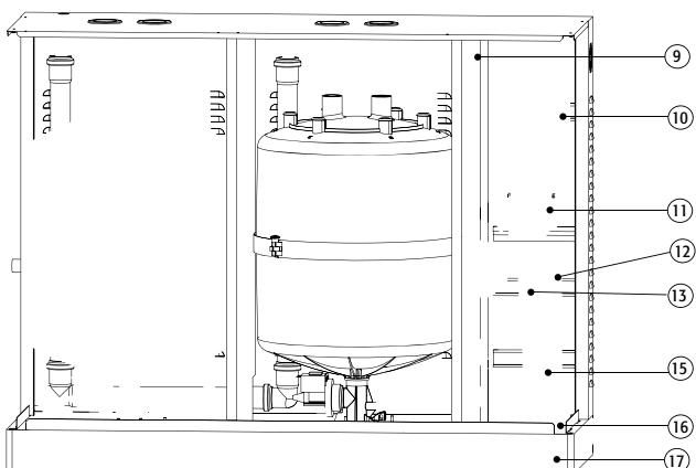
Таблица водного контура, электрических и электронных запасных частей, UER090 – UER130
