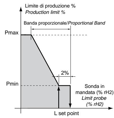
Рис. 14.c Управление с датчиком-ограничителем
