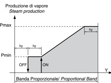
Рис. 14.a Пропорциональное управление
