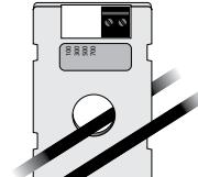
Два витка кабеля одной и той фазы
