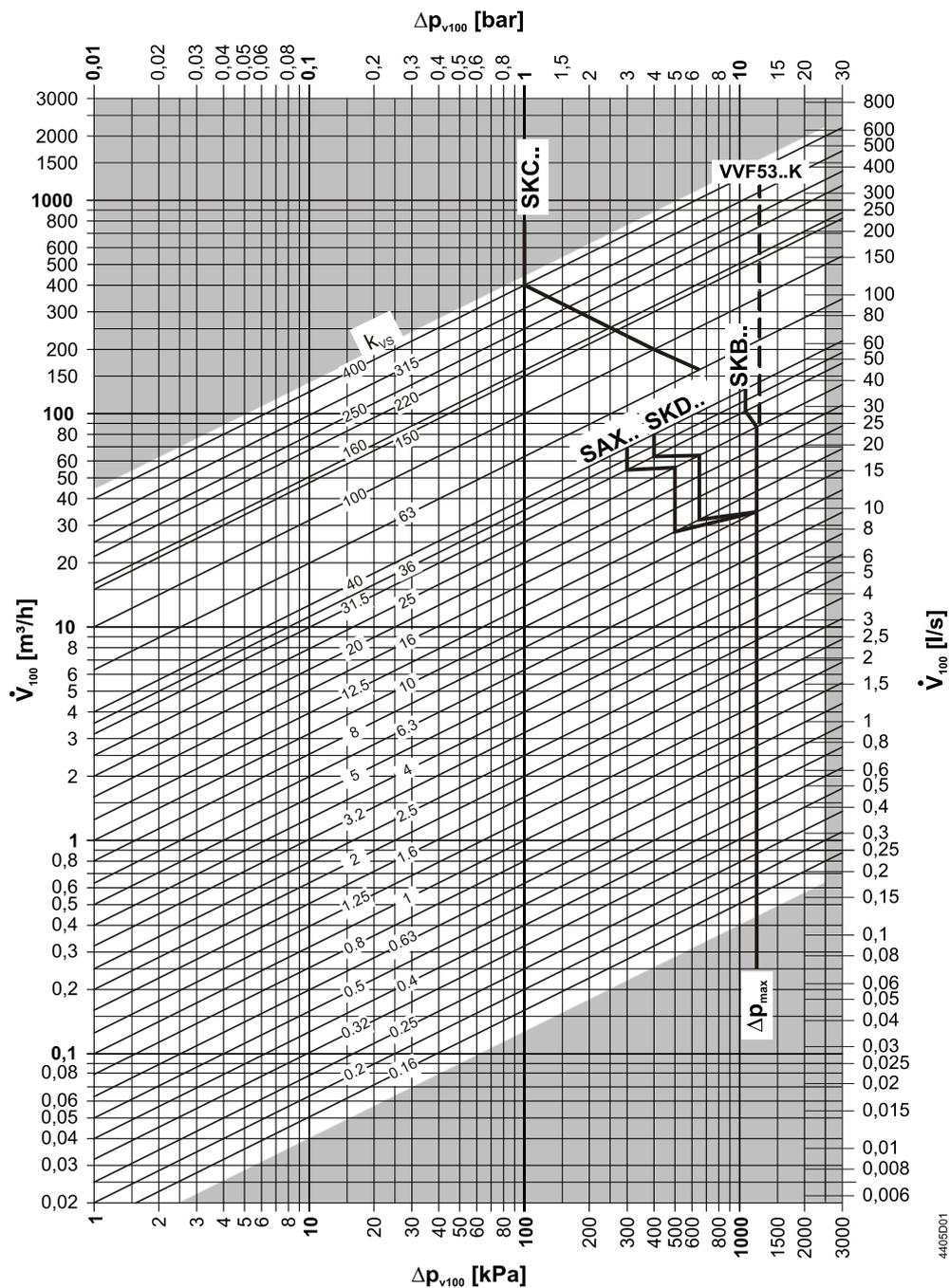
Значения  $\Delta p_{max}$  действительные для случая использования клапана в качестве смесительного. Значения  $\Delta p_{max}$  для случая работы клапана в качестве разделяющего, смотрите таблицу „Сводная таблица типов“ на стр.2. Значения  $\Delta p_{max}$  при  $kvs = 16, DN 32$  таблицу „Сводная таблица типов“ на стр.2.
